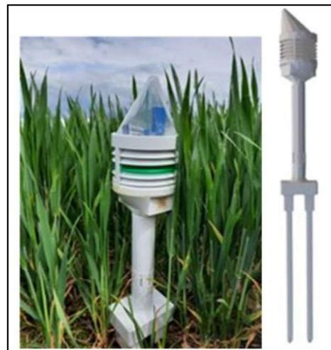
**Abbildung 10: Climavi-Mikroklimasensor im Weizenbestand.**
